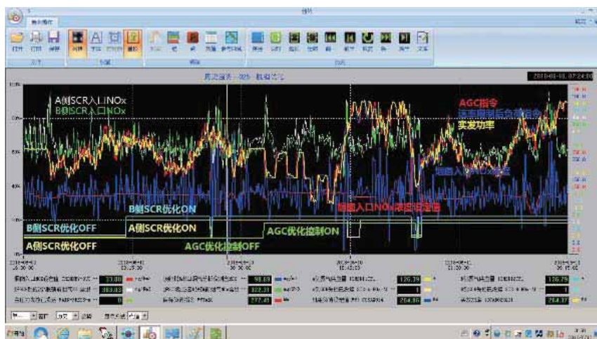
图12 优化控制投运前后的NO x 对比曲线
