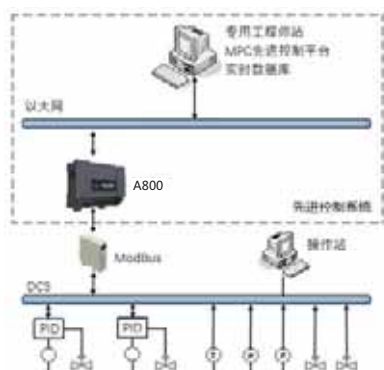
图6 非新华DCS系统实现优化控制的结构
